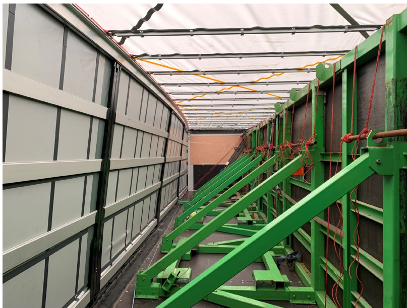
图5 侧墙强度试验
