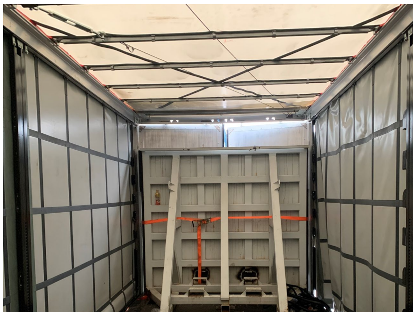
图5 侧墙强度试验
