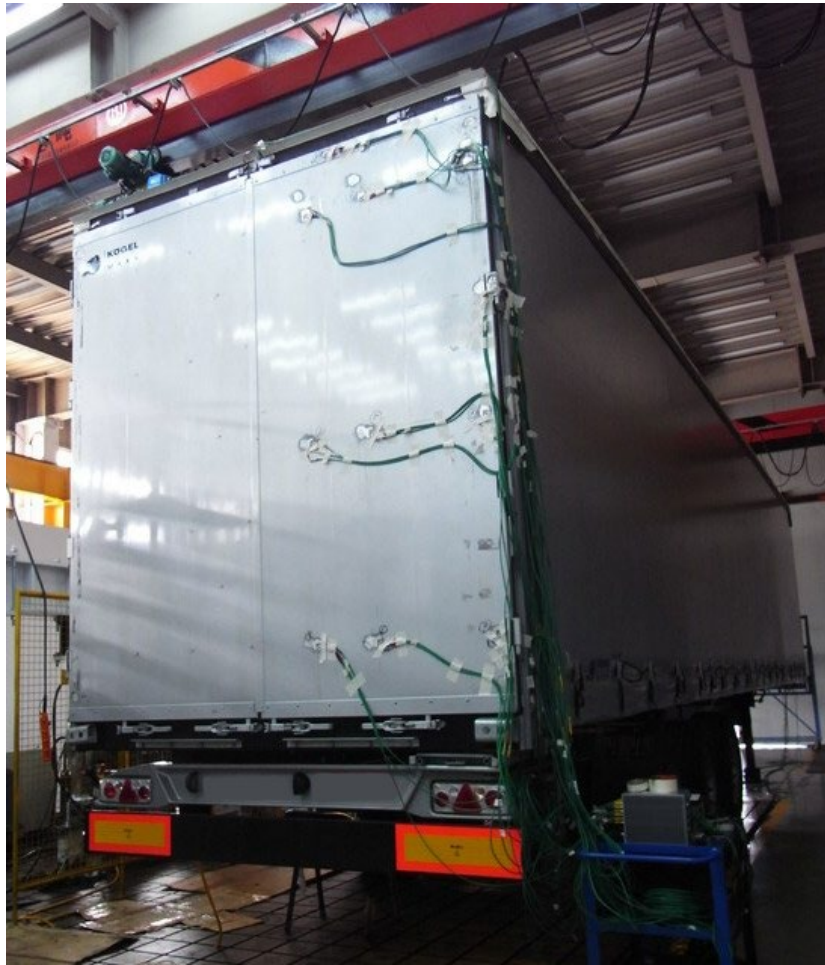
图6 后墙强度试验
