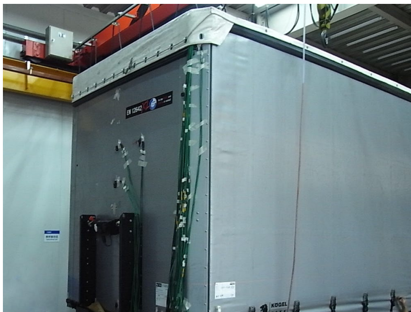
图7 前墙强度试验
