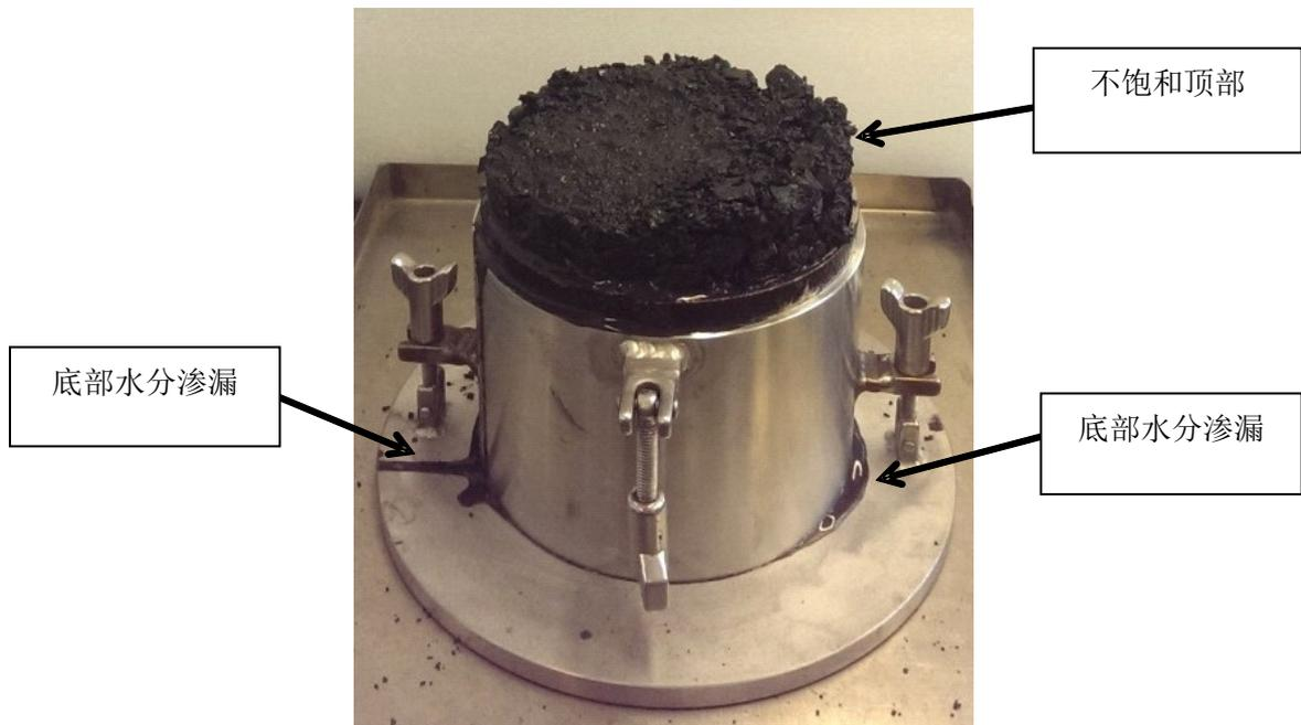
图 1.5.5.3.4.2 – 试验显示从圆筒模底部出现水分渗漏以表明水分渗移
