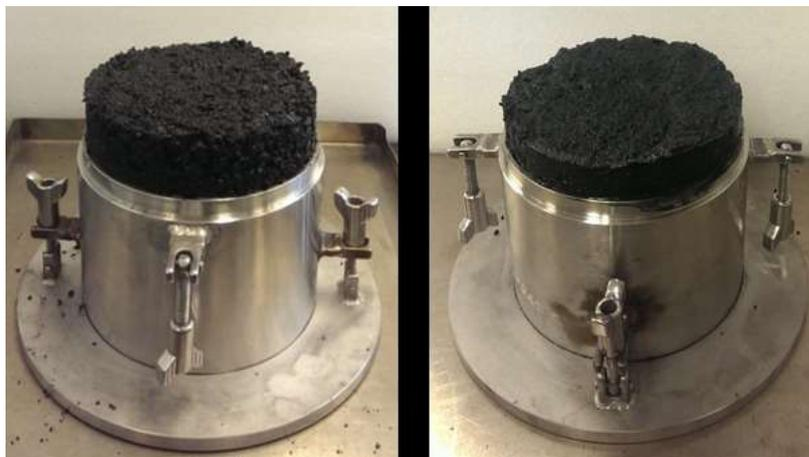
图 1.5.5.3.4.1 – 显示部分饱和测试部分（左侧）和接近饱和测试部分（右侧）有效试验图
