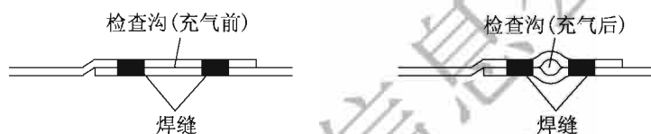
图 11-4 防水板焊缝检查示意图
