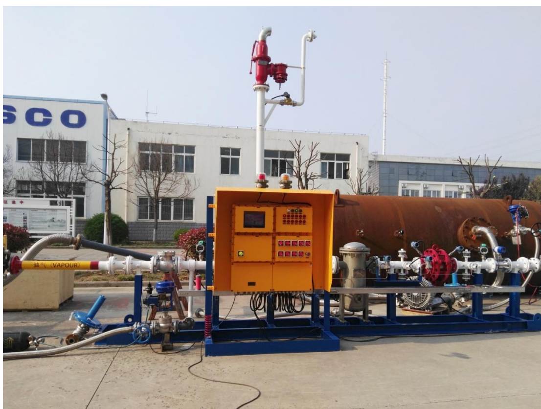
图 2-3 船岸界面安全装置样机全景图
