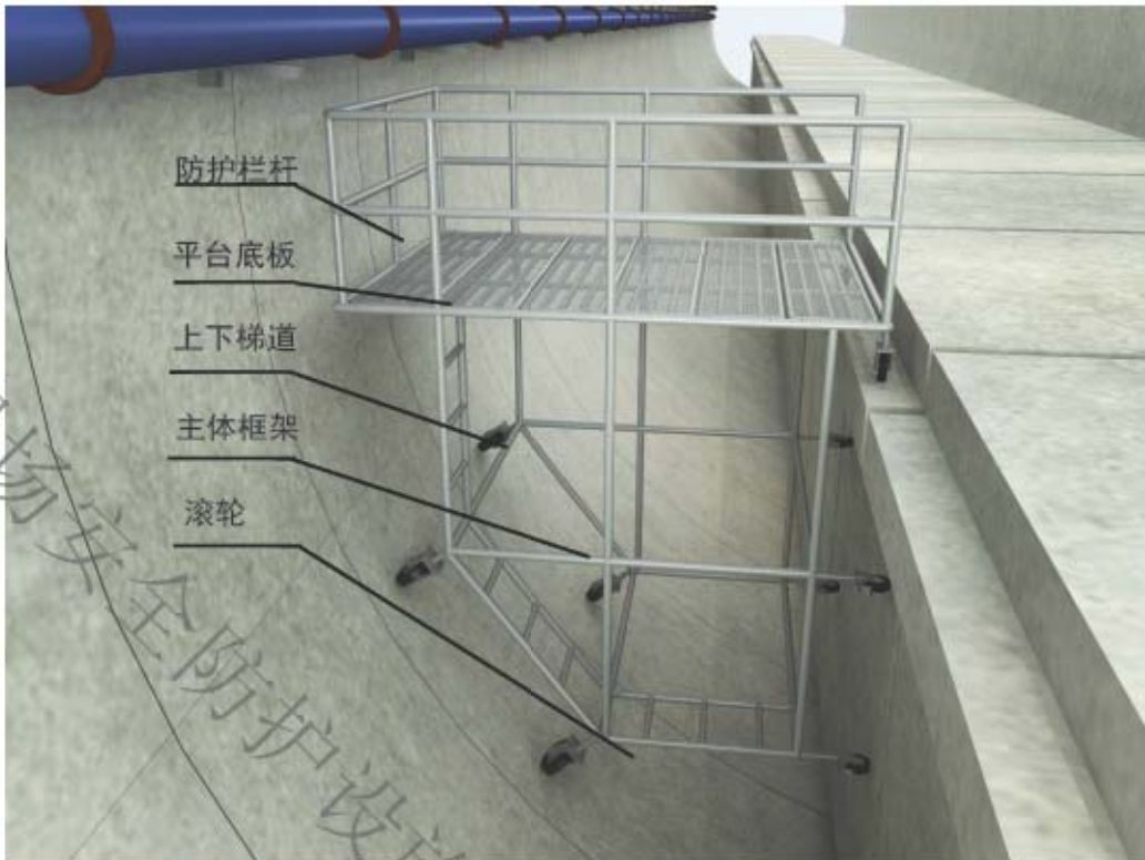
图 7.3.2.1 箱涵两侧移动式作业平台示意图
