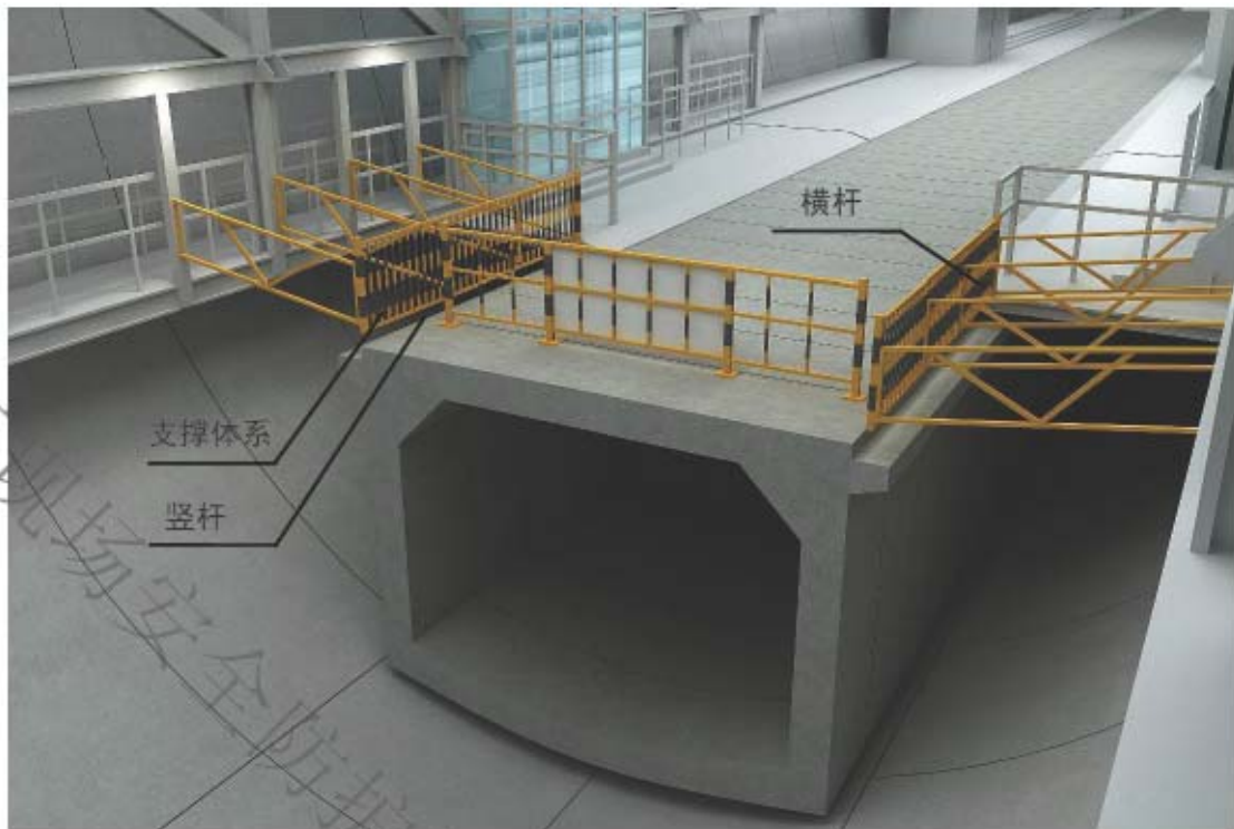
图 7.3.3.1 盾构箱涵拼装两侧移动护栏
