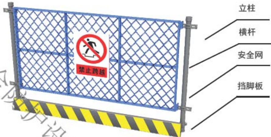
图 4.1-1 防护栏杆示意图
