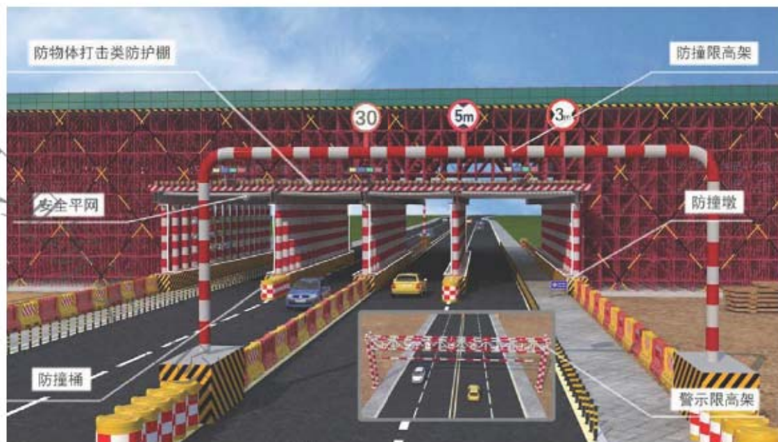
图 5.3.1.1-1 现浇支架跨线施工示意图
