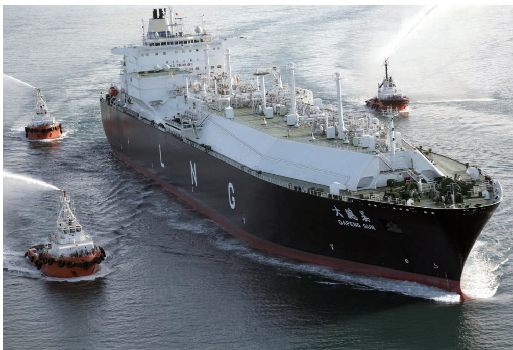
图 中国自行建造的 14.7 万立方米薄膜型液化天然气船
